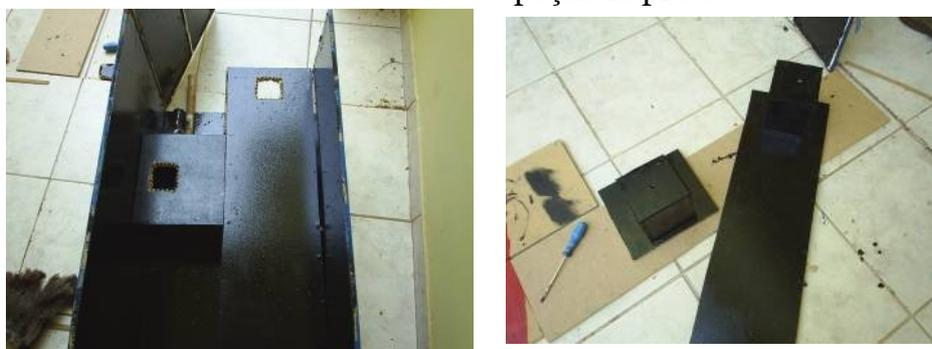
**Figura 5** – Buracos para a iluminação dos compartimentos e caixa para as lâmpadas
